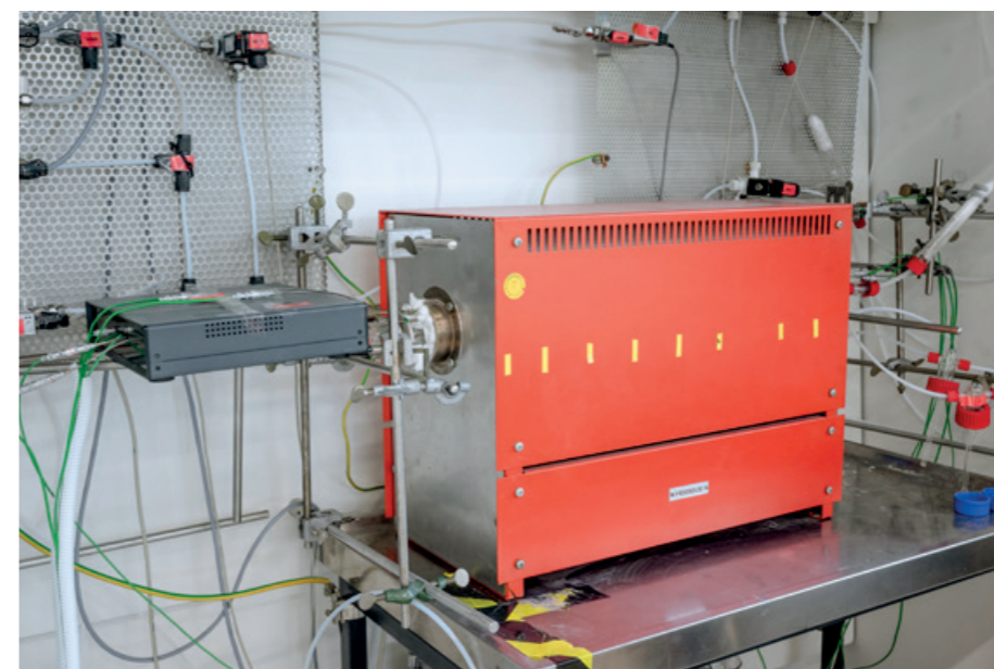
Diese Anlage dient in Prof. Agars Labor dazu, Methan bei Temperaturen von mehr als 1000 °C in Kohlenstoff und Wasserstoff zu zerlegen.
